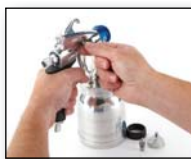
2 Przesuń język spustowy do zwolnienia iglicy
